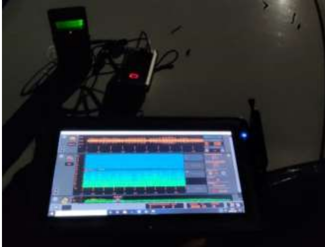
Photo 2 : Enregistreur D240 et Soundchaser utilisé lors de l'étude pour les points d'écoutes (Photo : Base interne CDPNE)
